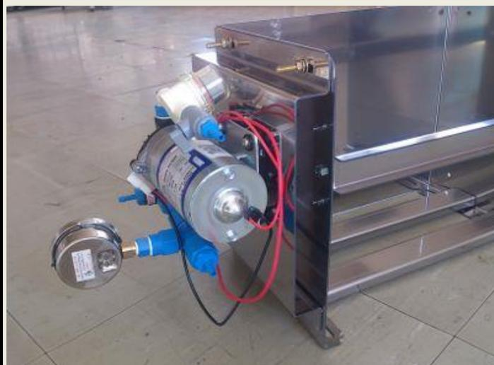
タンク架台の両側面に4カ所の丸穴がついています。この4カ所の穴はポンプ架台が取り付けられるようになっていますので、タンクとポンプ両方をセットで固定する場合写真のように取付けることが可能です。
