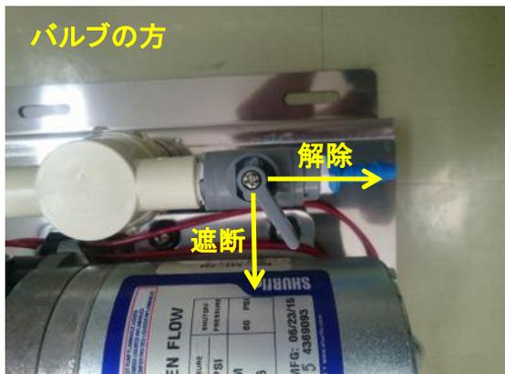
ボールバルブはタンクからの液体を確実に遮断します。
