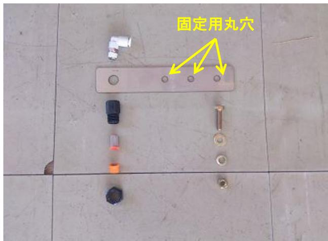
付属のM8×30mmのボルト(1セット)を使用しノズルプレートを固定してください。
