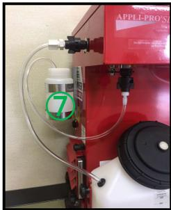
1. ⑦の水ボトルに水を十分に入れ、左の写真のようにホースを付け替える
